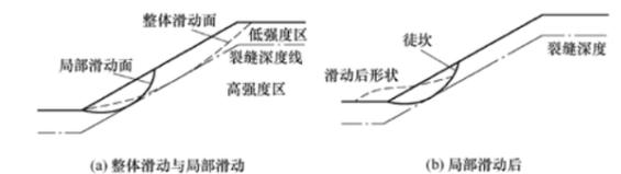
图2 膨胀土边坡滑坡特征示意图
