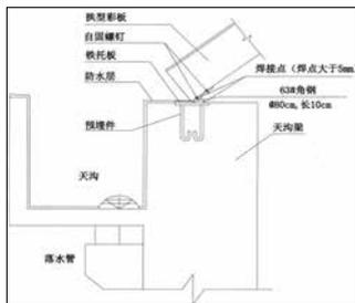
图3 屋盖板安装节点图
