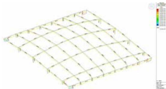
图11 只考虑非线性温差采光顶弯矩图 (单位: kN·m)
