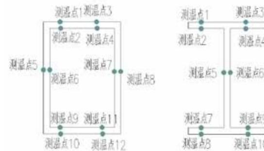
图4 构件测温点布置图
