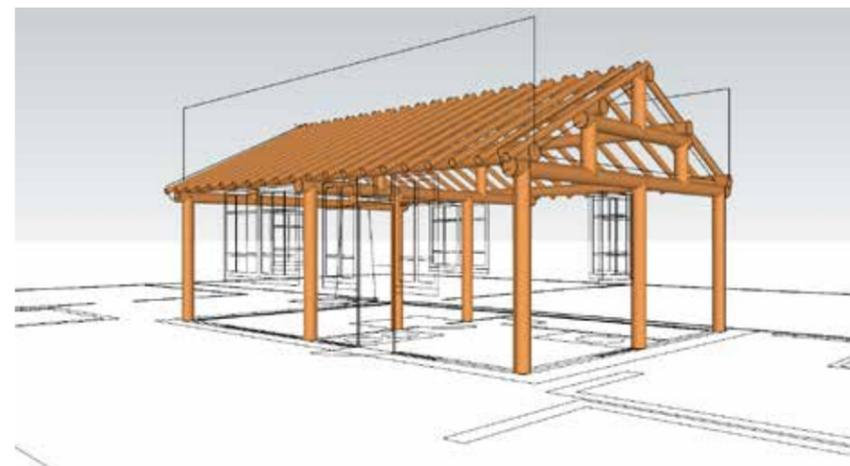
图5 梁架结构示意图
