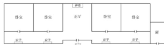
多开间的基本型石条瓦房平面图
